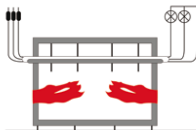
Tulepüsiivad kaablid Tulepüsiivus vastavalt testile DIN 4102/12 (kaablisüsteemi test, kõik süsteemi komponendid peavad olema ühtviisi tulepüsiivad)
